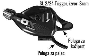
Sl. 2/24 Trigger, izvor: Sram
