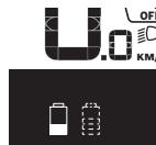
Worden bij een eBike met twee geplaatste accu's beide accu's op de fiets geladen, dan wordt op het display de laadvoortgang van de beide accu's weergegeven (op de afbeelding wordt net de linker accu geladen). Welke van de beide accu's net geladen wordt, kunt u ook zien aan de knipperende aanduiding op de accu.
