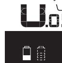
Jeżeli w rowerze elektrycznym z dwoma akumulatorami ładowane są obydwa akumulatory, na wyświetlaczu pojawi się wskazanie postępu ładowania dla obydwu akumulatorów (ilustracja pokazuje ładowanie lewego akumulatora). Migający wskaźnik na akumulatorze pokazuje, który z dwóch akumulatorów jest aktualnie ładowany.
