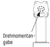
Abb. 5/23 Sattelstütze
