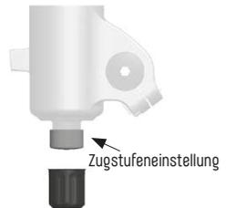
Abb. 2/45 Zugstufe Quelle: Fox
