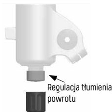
Rys. 2/45 Tłumienie powrotu źródło: Fox
